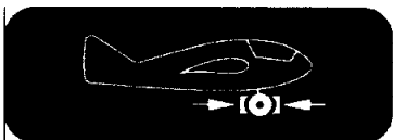
Lorsque la poignée de frein est tirée au maximum elle agit sur le frein de roue
